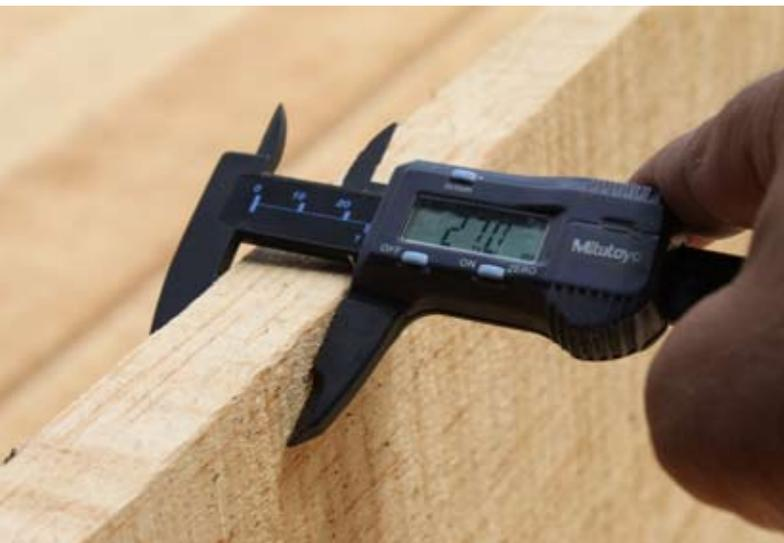
*Como control de la producción, el encargado o jefe del aserradero revisa varias veces durante el día los groesos de la madera aserrada. La medición puede hacerse con una amplia variedad de equipos, desde calibradores electrónicos hasta flexómetros. En la foto se muestra una pieza que excede en 2 mm su grueso comercial equivalente a 25 mm o una pulgada. Cuando este efecto se repite a lo largo de la producción, la pérdida del aserradero es significativamente considerable.*
