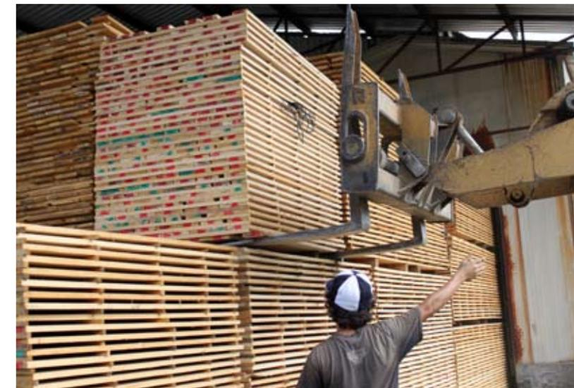
ARRIBA. Apilado de madera para el secado en la estufa, nótese la uniformidad en el grueso de las piezas.
