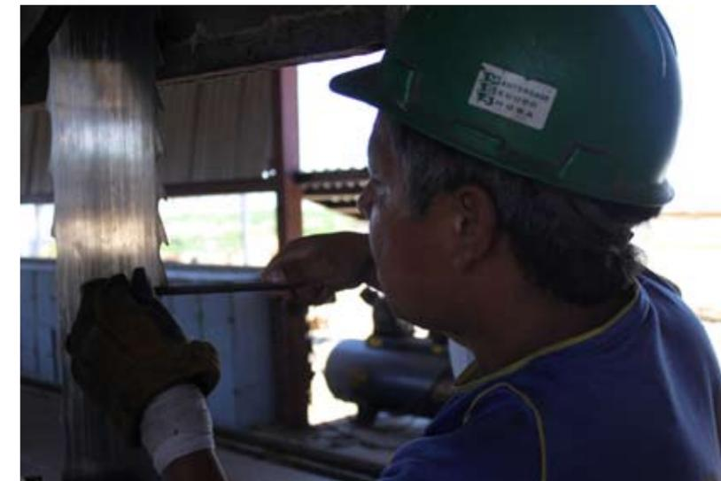
*Aunque se recomienda que el cambio de la sierra cinta se haga cada 3 o 4 horas, el aserrador determina el momento preciso para acondicionar la sierra, según factores como la velocidad del corte, la calidad del maquinado y la capacidad de la sierra cinta. Proforsa.*
