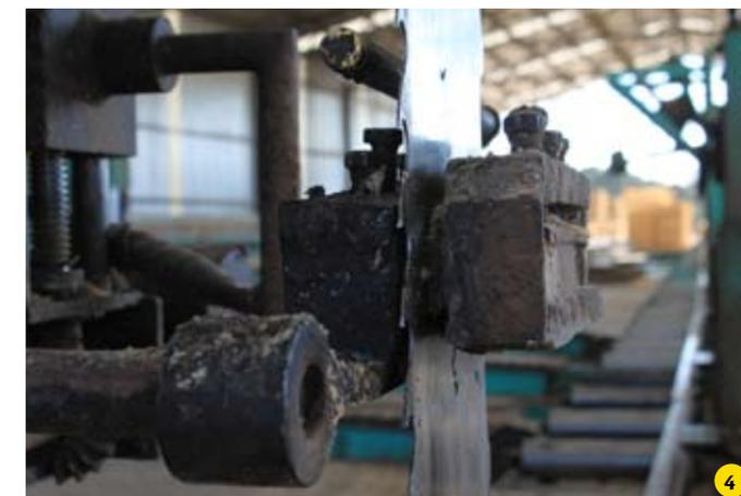
1. Sistema mecánico de palometas en el banco de volteo: incrementa el rendimiento y disminuye el esfuerzo excesivo de los trabajadores.
