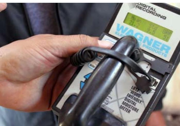
*Medición del porcentaje de humedad de la madera con un equipo digital. El operador deberá supervisar constantemente el progreso del secado, midiendo varias muestras repartidas por toda la carga para obtener una medida representativa. Forestal Vizcaya.*
