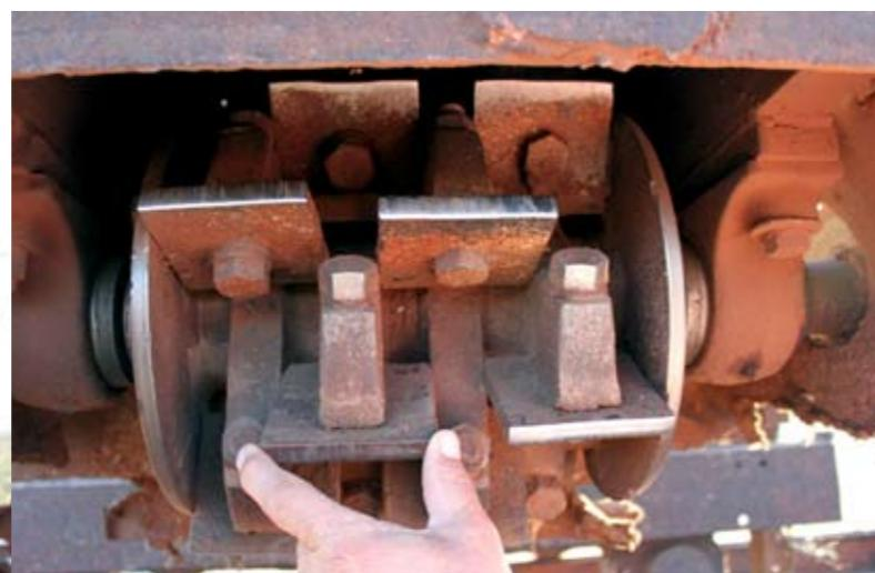
za. Asimismo, el funcionamiento de la descortezadora se diagnostica observando la superficie de la troza después del desprendimiento de la corteza y el tipo de material que predomina en la corteza triturada (subproducto).
