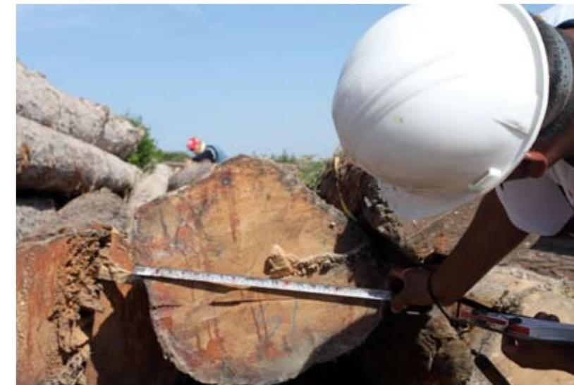
*Medición de la trocería en el patio mientras se recopilan los datos en la lista de recepción de la madera en rollo. Proforsa.*
