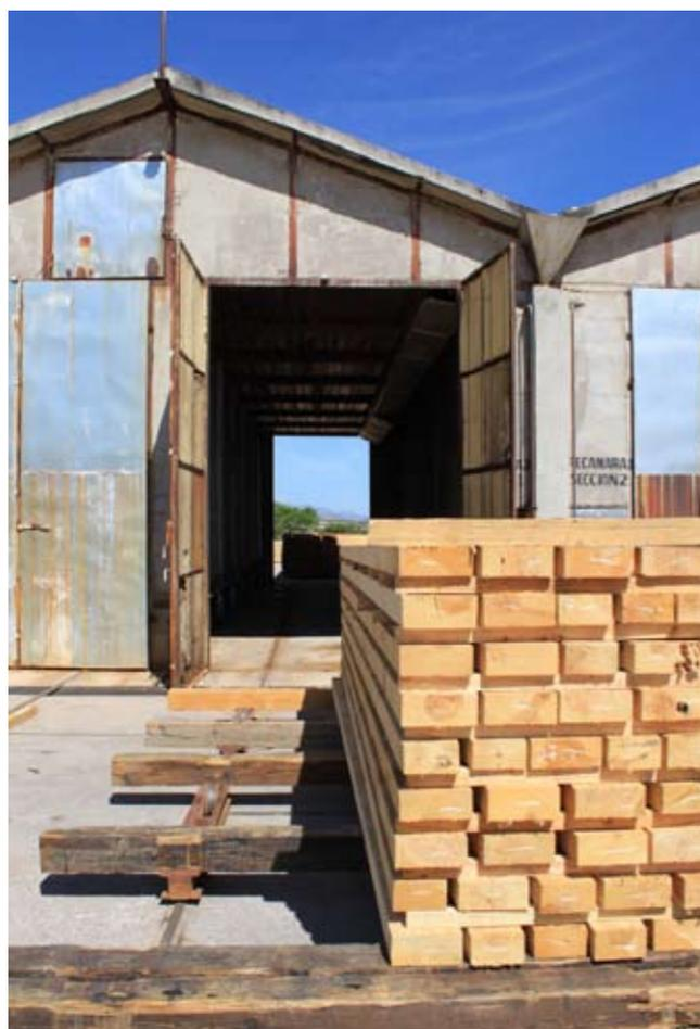
**3.** Transportar la madera ya estibada a la cámara de secado mediante el uso de un trascabo o un montacargas. La preparación de la carga se hace en función del espesor de las piezas y de ocupar al máximo la capacidad de la cámara de secado. Lo ideal es que las cargas contengan madera de un solo espesor, así se garantiza que el aire no encontrará obstáculos y fluirá parejo por todas las piezas, disminuyendo el riesgo de daños en la madera.
