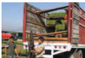
Estructura metálica para el correcto traslado de la planta en los contenedores de producción.
